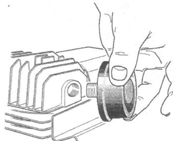
Навинтите воздушный фильтр на верхнюю часть цилиндра, как показано на рисунке. Если в компрессоре 2 или 3 цилиндра, то необходимо накрутить фильтр на каждый цилиндр.
